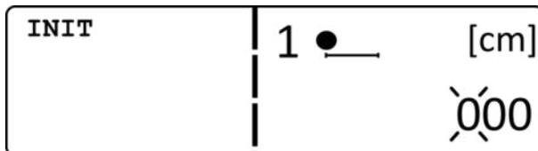
Der Umfang des Laufrades in cm kann eingegeben werden. Die Sensornummer des Laufradsensors ist immer die **Nummer 3**.
